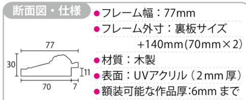
断面図・仕様 ●フレーム幅：77mm
