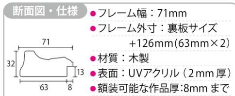
断面図・仕様 ●フレーム幅：71mm
